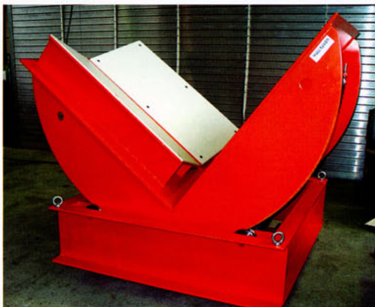
Der Coil- und Werkzeugwender mit elektromechanischem Antrieb spart Platz und kann von einer Position aus be- und entladen werden
