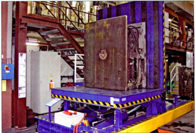
Bis zu 25 Tonnen wiegen die Spritzgießwerkzeuge, die Takata-Petri Plastec im Werk Bad Kissingen, für Wartungsarbeiten auch wenden muss. Hierfür kommt seit 2005 diese Wendemaschine zum Einsatz
