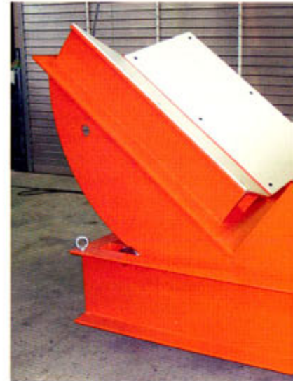
Dieser Ballenwender arbeitet mit einem elektromechanischen Antrieb.
